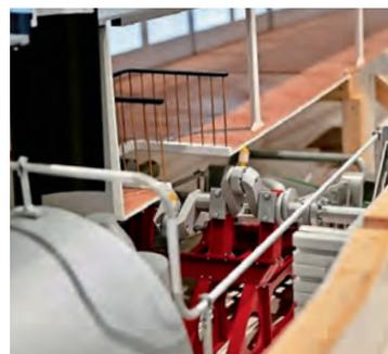
Testmotor aus dem 3-D-Drucker.
